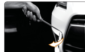
بکسل کردن به وسیله قلاب بکسل
